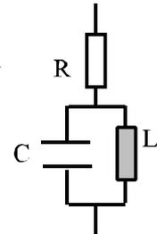
Determinamos en primer lugar la impedancia equivalente del conjunto formado por el condensador y la bobina.
