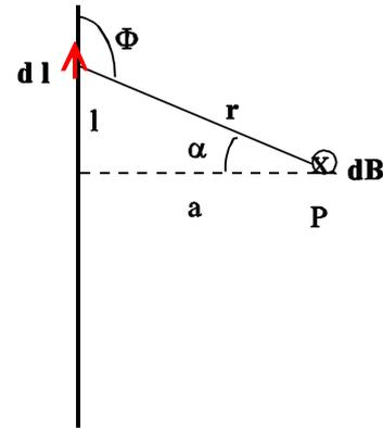
En el punto P el campo creado por el elemento de corriente dibujado en rojo tendrá por valor ( Ley de Biot y Savart )
