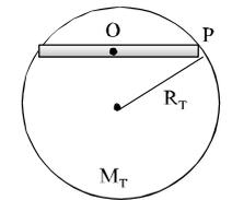
Representemos el diagrama de fuerzas, que actúan sobre el vagón en el segundo caso. Está sometido a la fuerza gravitatoria y a la de contacto sin rozamiento, siendo C el centro de la Tierra,  $R_T$  el radio de la misma, r la distancia del vagón a C y x la posición del vagón con respecto al punto O
