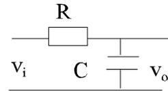
Para el cálculo del voltaje a la salida utilizaremos que el sistema es un divisor de voltaje.
