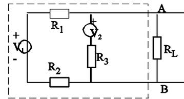
Por tanto el voltaje Thévenin entre A y B sin  $R_L$  lo calcularemos resolviendo el circuito siguiente
