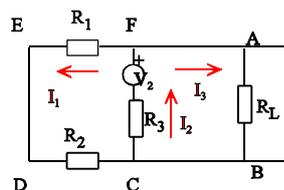
Aplicamos la ley de Ohm al primer circuito para el cálculo de  $I_1$  y el divisor de corriente para  $I_2$  e  $I_3$
